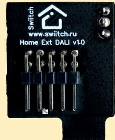
**⚠ ВНИМАНИЕ!** Контроллер с модулем расширения Ext DALI v1 необходимо запитывать **ТОЛЬКО** от блока питания 12-16 В. При использовании блока питания с большим напряжением могут выйти из строя подключенные устройства DALI!
