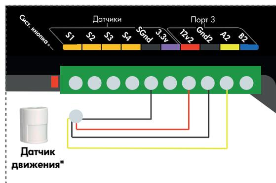
\* если контроллер питается напряжением, отличным от 12 В, следует запитать датчик движения от другого блока питания с выходным напряжением 12 В
