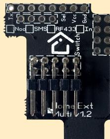
Модуль расширения для контроллеров линейки Swiitch Home. Добавляет 2 дополнительных входа для подключения проводных датчиков температуры, выключателей, кнопок или контактных счетчиков.
