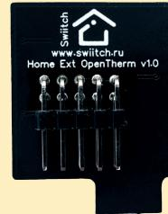
Модуль расширения для моделей линейки контроллеров Swiitch Home.
