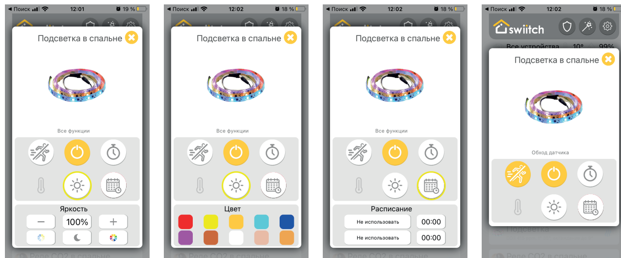
Приложение Switch: меню управления устройством типа светодиодная лента (1), выбор цвета для RGB-ленты (2), настройка расписания работы (3), блокировка привязанного датчика (4)
